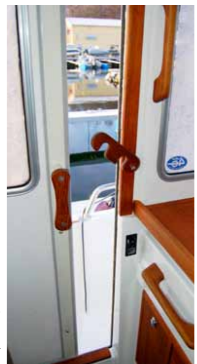
Dörrkläppen som ska hålla dörren stängd ser mycket rejäl och funktionell ut. Men den klarar inte jobbet riktigt. Vi fick hålla fast den när färden blev skumpig.
